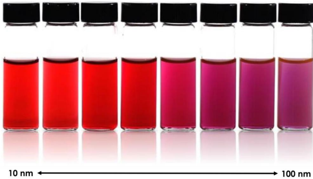
Figura 1.2 Variación del color de las nanopartículas de oro en función de su tamaño. Imagen tomada de [16].
