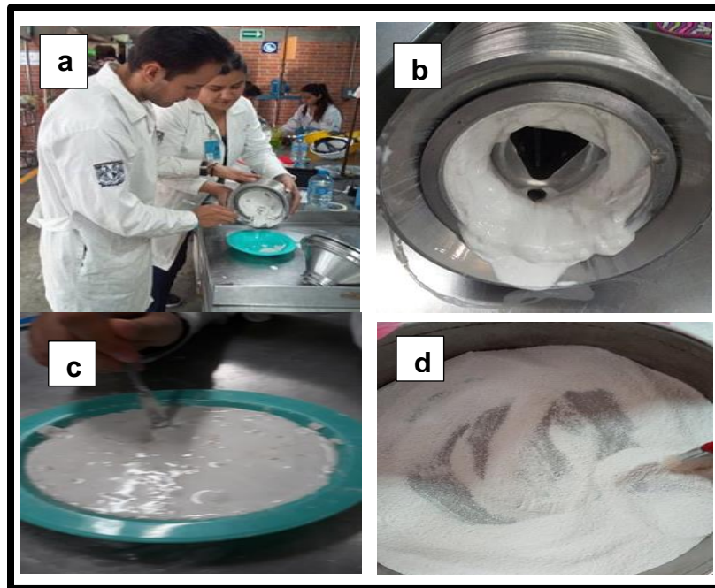
Figura 16 Separación mecánica de almidón de amaranto, a) recolección de almidón del tazón, b) recuperación de los discos, c) eliminación de agua por arrastre de aire, d) almidón seco.
