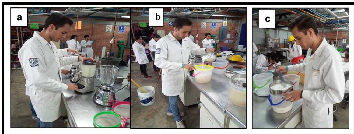
Figura 13 Molienda húmeda y tamizado del amaranto húmedo, a) molienda, b) colado, c) tamizado.
