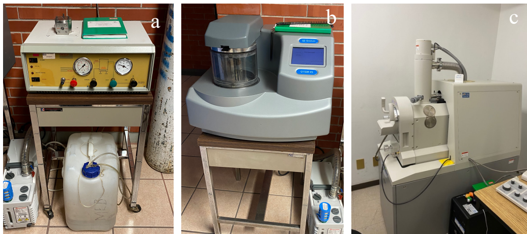
Figura 12. a) Aparato de secado a punto crítico, b) Metalizador y c) Microscopio electrónico de barrido.
