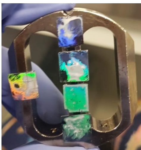
Figura 10. Sustratos de silicio depositados con microesferas de sílice antes de su caracterización en el microscopio electrónico de barrido (SEM).
