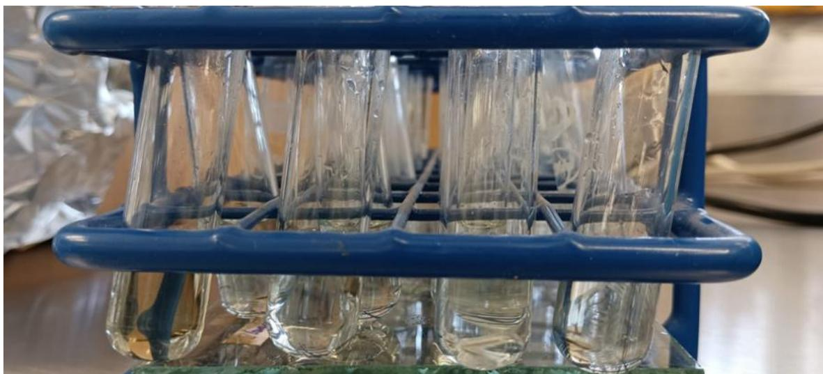
**Figura 9.** Muestras después de la digestión (de izquierda a derecha blanco y muestras).
