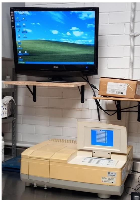
**Figura 4.** Espectrofotómetro Shimadzu™ UV-1601 acoplado a sistema informático.
