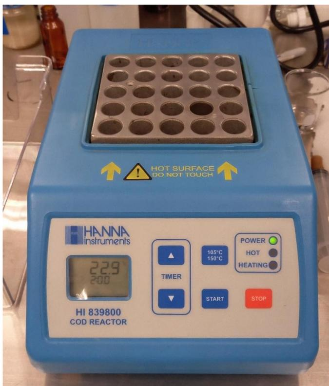
**Figura 5.** Bloque digestor para viales de DQO Hanna® modelo HI 839800.
