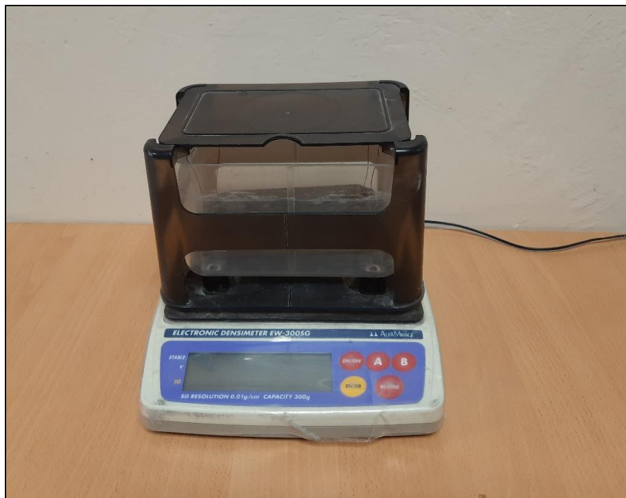
Figura 32. Densímetro electrónico modelo EW-300SG, de la marca AlfaMirage.
