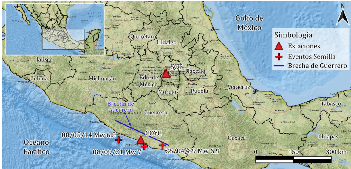
Figura III.4. Localización estaciones empleadas para las simulaciones, de la brecha de Guerrero y de los epicentros de los sismos usados como EGF.
