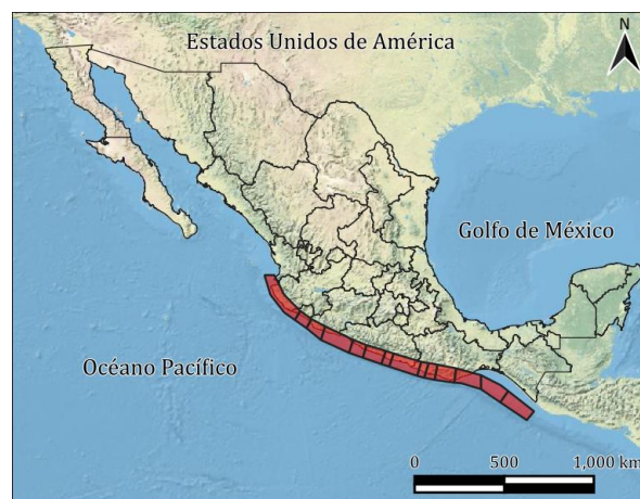
Figura III.3. Fuentes sísmicas en México para sismos interplaca (modificada de CFE, 2015).
