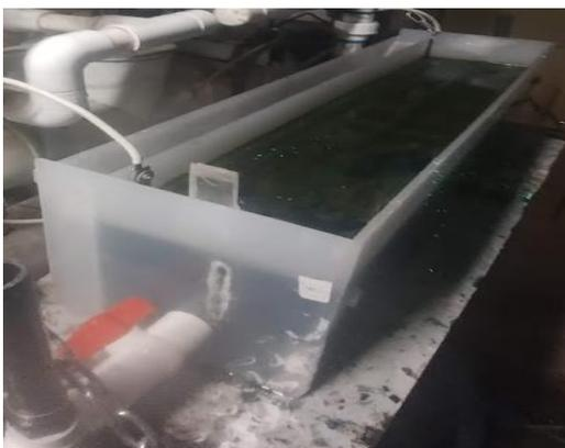
Figura 13. Reactor con electrodos de hierro.
