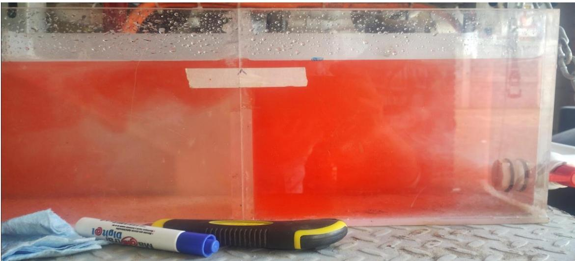
Figura 12. Pruebas hidráulicas de Reactores de ionización electroquímica
