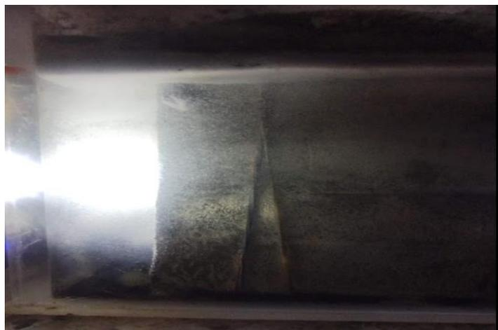
Figura 15. Formación de flóculos en reactor de aluminio
