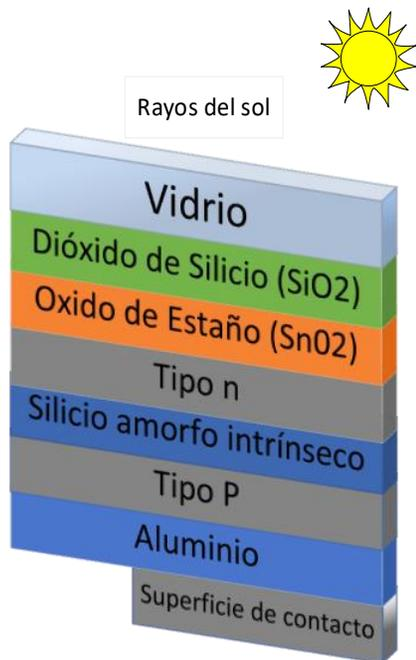
Imagen 1.6: Esquema en vista vertical de los componentes de una celda solar.
