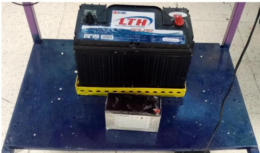
*Imagen 4.6: Corral elaborado para sostener la batería, puesto en la placa inferior del módulo.*
