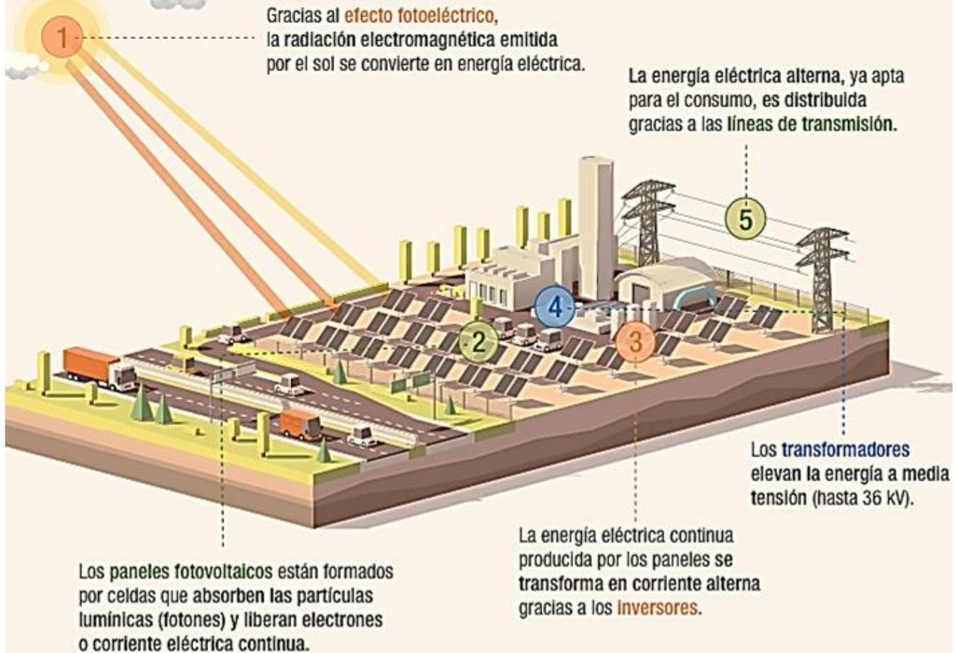
Imagen 1.13: Los sectores que componen una planta de energía fotovoltaica (imagen obtenida de la página web oficial de IBERDROLAS).
