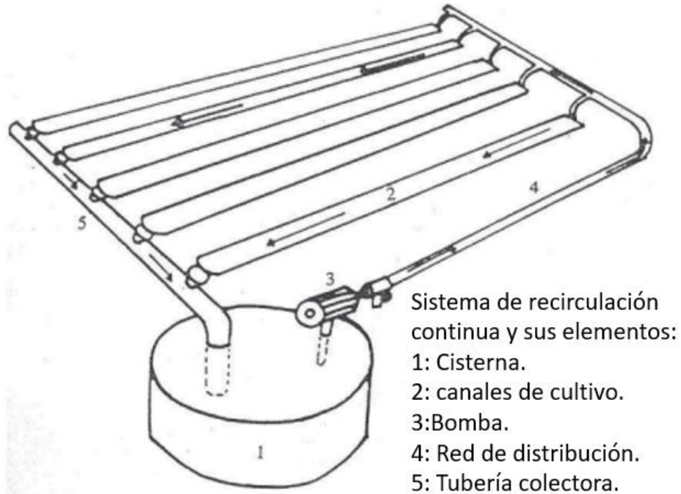
Figura 2. Esquema sistema NFT. (Gilsanz, 2007).
