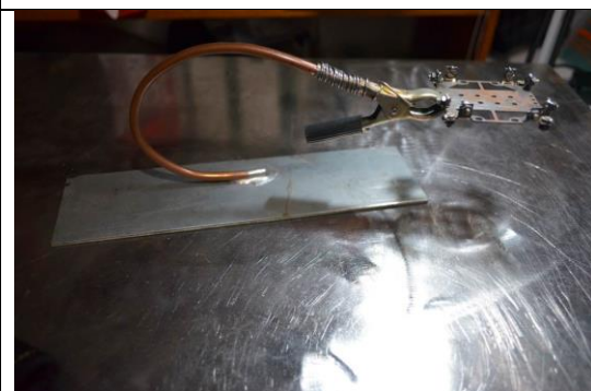
Figura H.5. Soporte para soldar con proceso TIG sobre piezas de lámina de 1mm.
