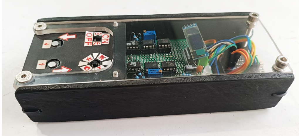
Figura H.12. Interfaz de usuario con cuatro botones; dos de los cuales son sensores de fuerza de alta precisión. Circuito de amplificadores instrumentales, mini-display, y convertidor analógico-digital de 4 canales. Interfaz controla cabezal de iluminación (ángulo de proyección, posición del mecanismo de persianas, intensidad luminosa de los módulos LED y altura del cabezal).
