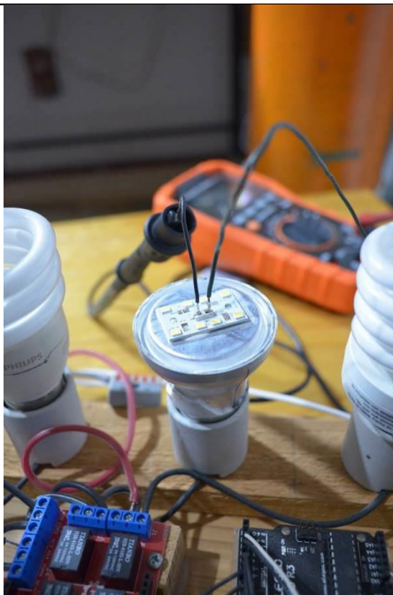
Figura G.2. Adaptación de foco LED para construcción de luminaria con tres módulos.
