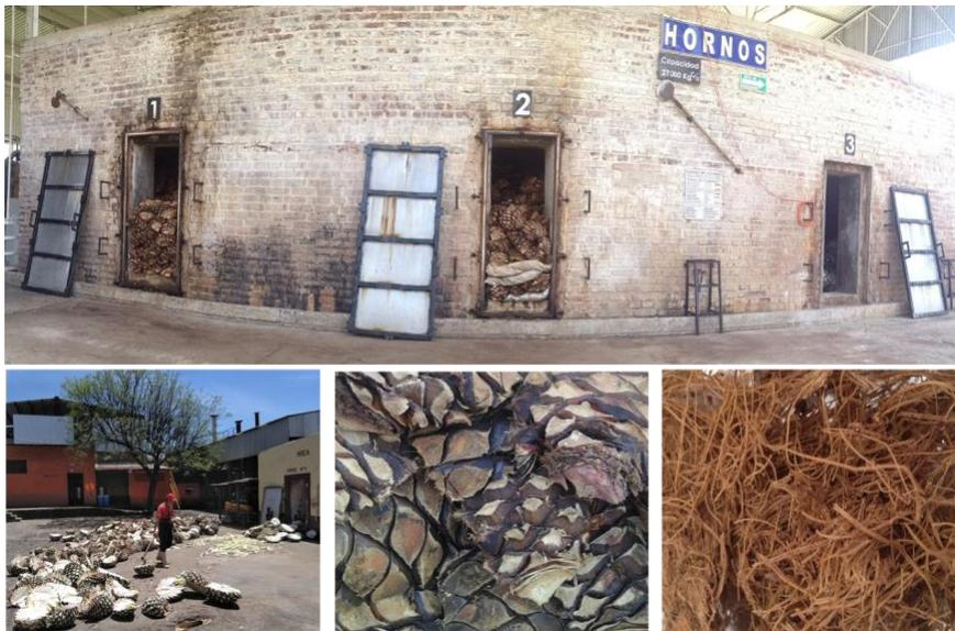
**Figura 22.** Troceado de piñas, hornos de cocción y fibras de bagazo como parte del proceso de producción de tequila. Morales García, 2018.
