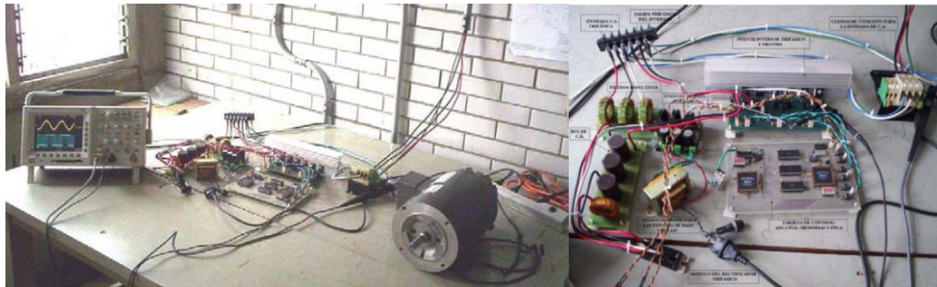
Figura 3. Implementación de un algoritmo SV-PWM en un FPGA para control de motores de inducción.
