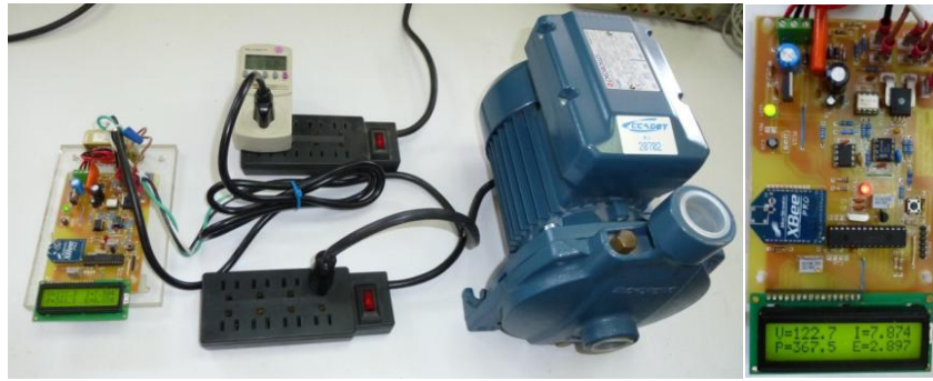
Figura 2. Medición inalámbrica del consumo eléctrico para el ahorro de energía en edificios.
