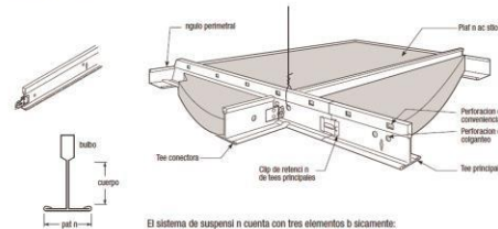
El sistema de suspensi n cuenta con tres elementos b sicamente:
