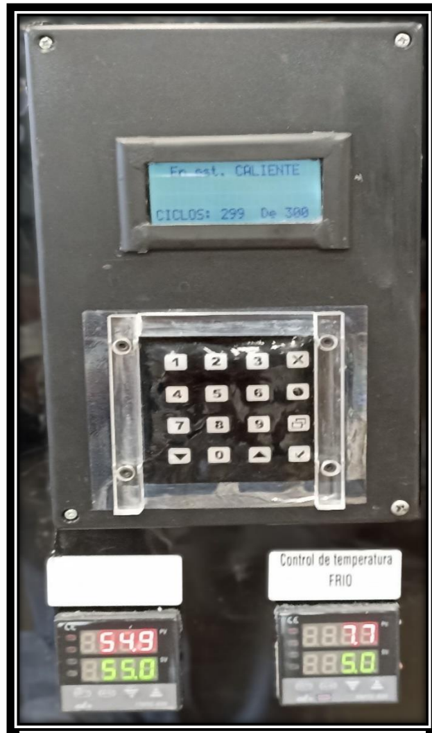
FIGURA 43. PROGRAMACIÓN DIGITAL DE LA TERMOCICLADORA (fuente propia)
