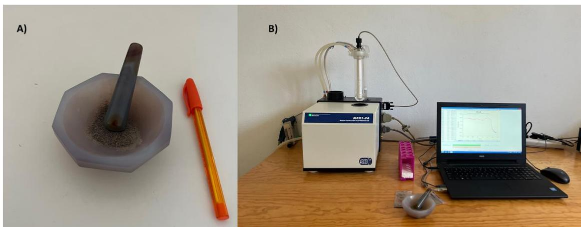
Figura 6.1. Detalle del susceptibilímetro utilizado para medir las muestras. A) Muestra pulverizada y B) susceptibilímetro AGICO MFK1.
