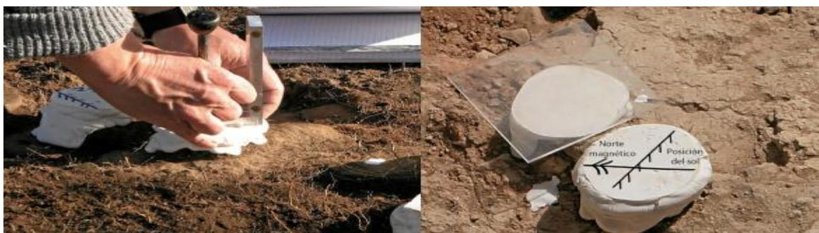
Figura 3.1. Toma y orientación de la muestra con la escayola colocada en la superficie, Gómez-Paccard *et al.*, 2016.
