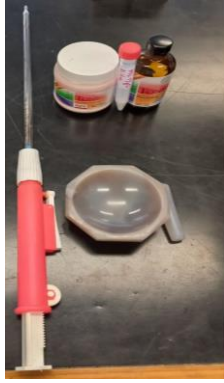
Imagen 22. pipeta colocada en un propipetero, mortero de ágata, resina acrílica RV2 autopolimerizable NicTone® y nanopartículas de MgO.
