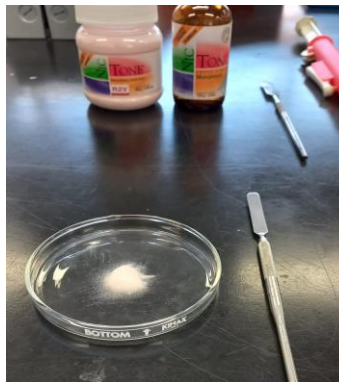
Imagen 14. resina acrílica RV2 autopolimerizable de la marca NicTone® en un vidrio de reloj.
