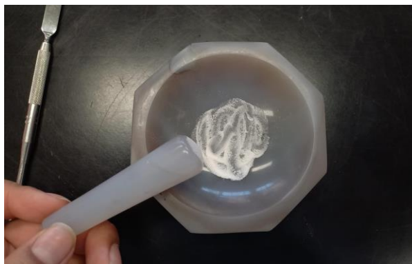
Imagen 6. Mg(OH)_2 en el mortero de ágata.
