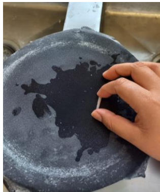
Imagen 24. Retirando los excedentes con un papel abrasivo de grano 600.
