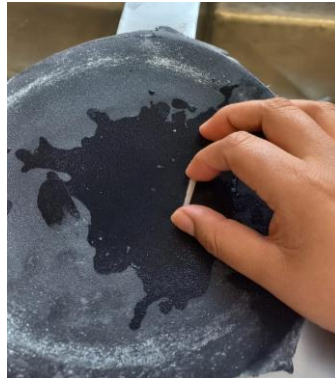
Imagen 16. Retirando los excedentes con un papel abrasivo de grano 600.
