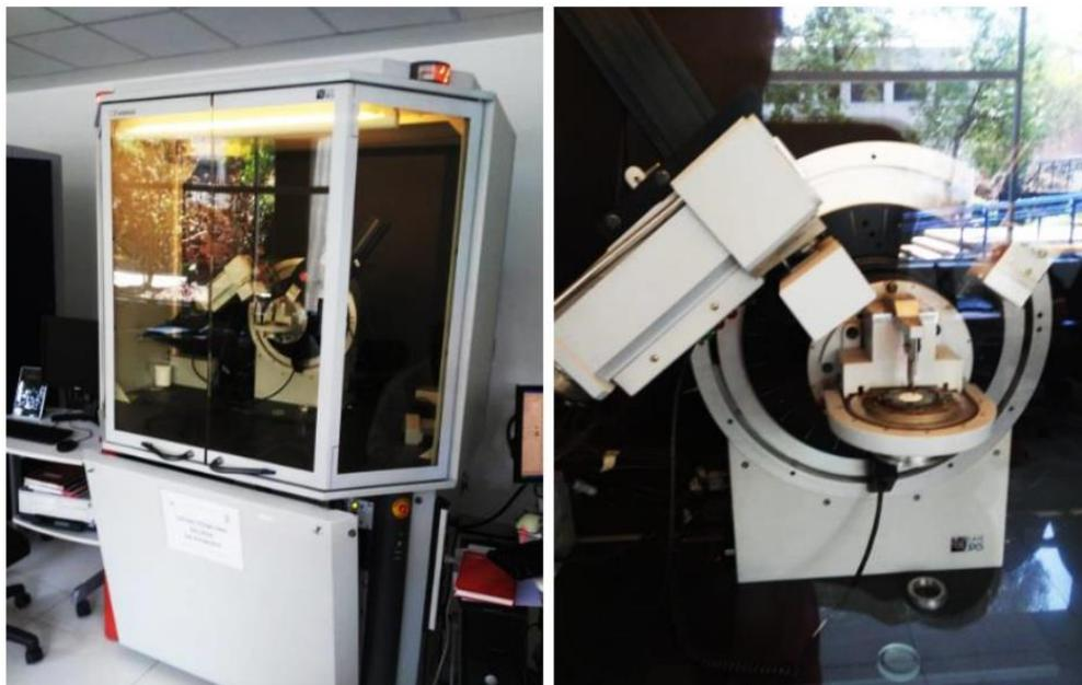
**Figura 21.** Difractómetro Bruker D8 Advance Eco.
