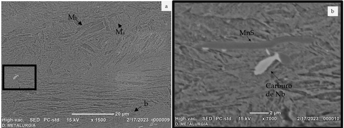
**Figura 39.** Micrografías de MEB de acero de fase compleja después de ser atacado con Lepera modificado: (a) B0-TD 7000x y (b) B0-TD 1500x
