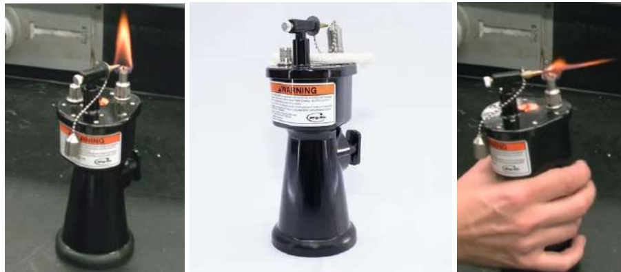
Figs. 116, 117 y 118: Ejemplo de mechero de alcohol, el mechero Hanau puede flamear, esta función puede funcionar para alisar los modelados en cera. (58, 59)
