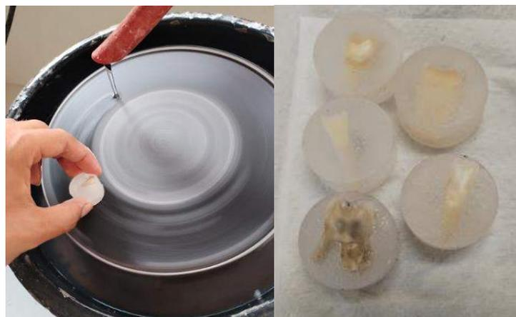
**Figura 23. Exposición de la dentina con papel abrasivo de grano 240 en la pulidora BUEHLER LTD; Muestras con exposición de la dentina. Fuente propia**
