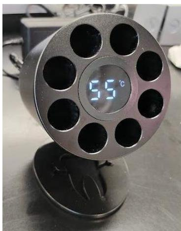
Figura 12. **Calentamiento del aditamento a 55°C, fuente propia.**
