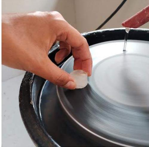
**Figura 8. Pulidora BUEHLER LTD, con papel abrasivo de grano 240. Fuente propia**
