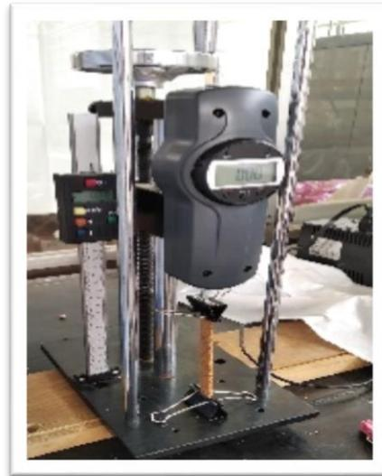
**Figura 14.** Determinación del módulo de elasticidad.
