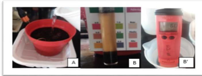
**Figura 16.** Determinación de pH (A) Filtración de agua neutra (B) Pastillas reactivas, (B') Potenciómetro.
