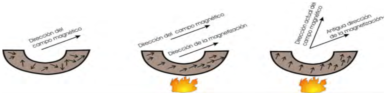
Figura 2.7: Adquisición de la magnetización termoremanente en un artefacto arqueológico (Soler-Arechalde, 2006)
