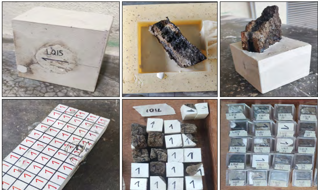
Figura 4.8: Preparación de las muestras para los experimentos de AFD y medición de la NRM.
