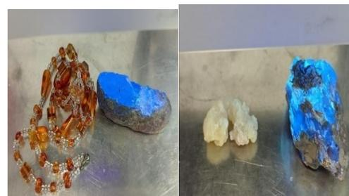
Figura 37. Prueba con la lámpara de luz ultravioleta para algunas muestras falsas y reales.
