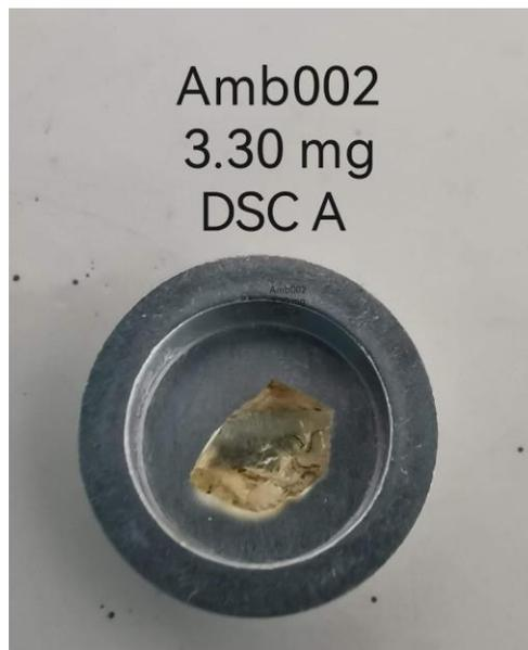
Figura 17. Muestra de Amb-02 para la prueba por DSC.
