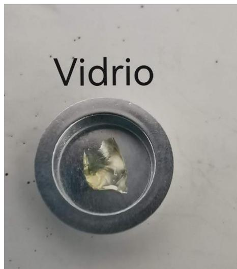
Figura 27. Muestras de Fals-01 para la prueba de DSC
