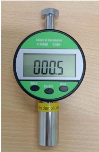
Figura 38. Durómetro digital Shore D.
