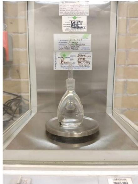
Figura 41. Picnómetro calibrado para la prueba de densidad.
