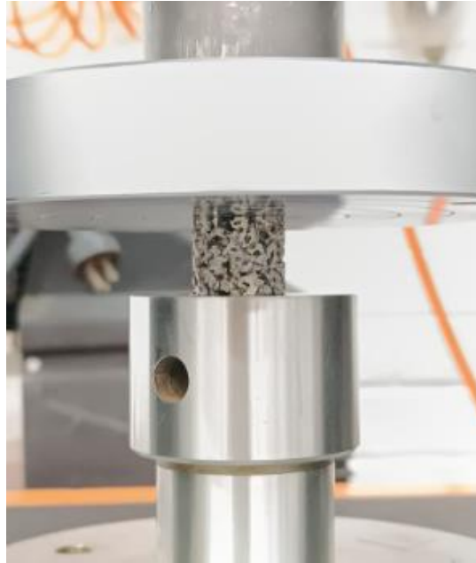
Figura 43. Montaje de las muestras en la máquina de ensayos universales.
