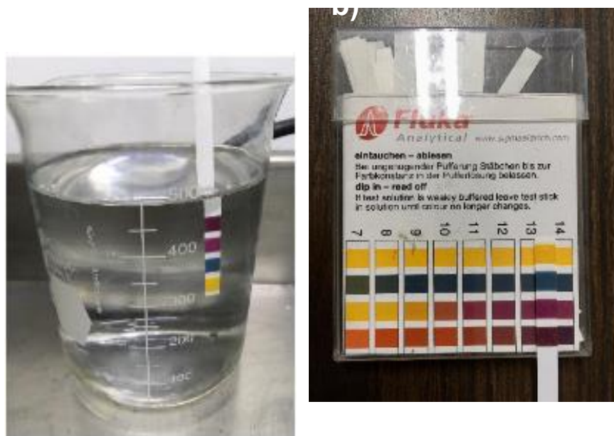
Figura 34. Preparación de una solución alcalina de NaOH con agua destilada para la eliminación de la preforma. a) vaso de precipitados con la disolución y b) comparación del pH de la disolución [27].
