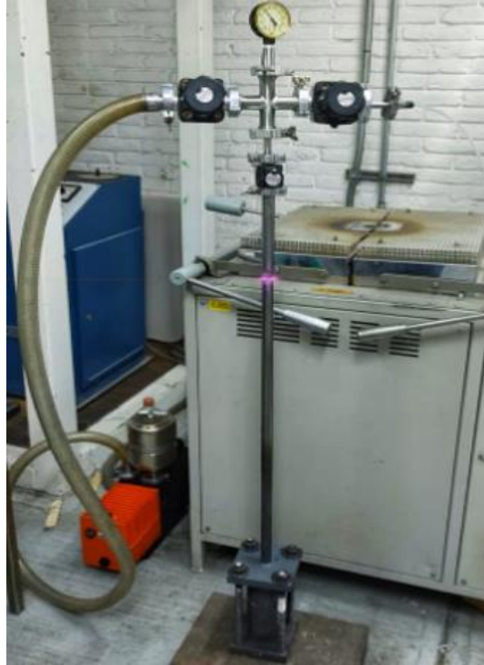
Figura 29. Sistema conectado con válvulas listas para el proceso de infiltración.
