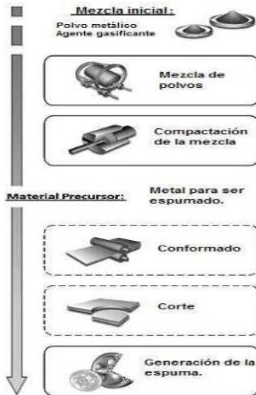
Figura 13. Diagrama de producción de espumas metálicas por medio de metalurgia de polvos [42].
