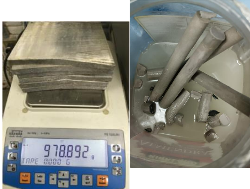
Figura 21. Materia prima empleada para aleaciones: a) Lingotes de magnesio y b) cilindros de litio.
