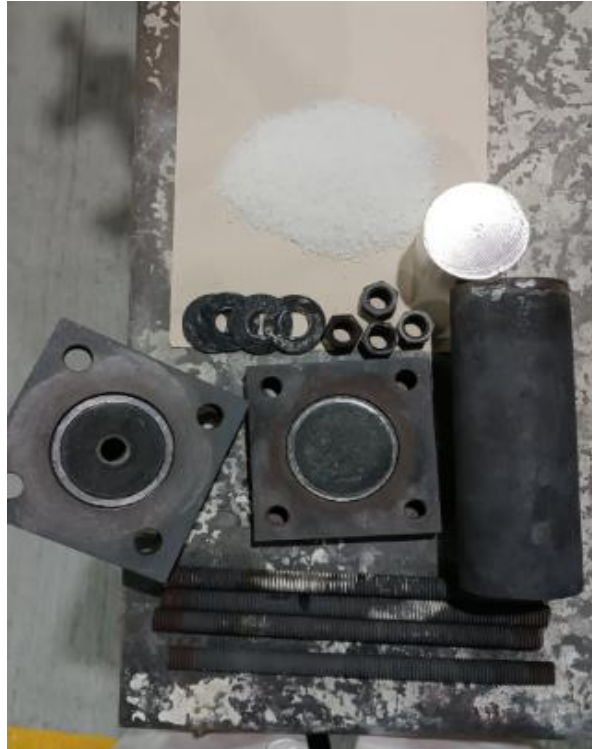
Figura 27. Componentes para el ensamble del reactor para la fabricación de espumas metálicas.
