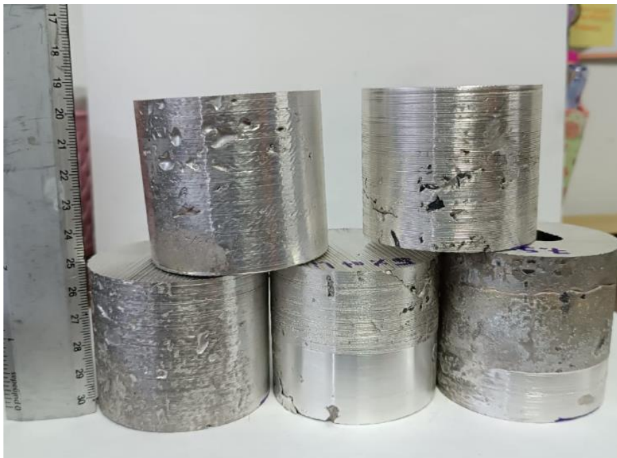
Figura 33. Cilindros de espumas metálicas después de ser maquinados.
