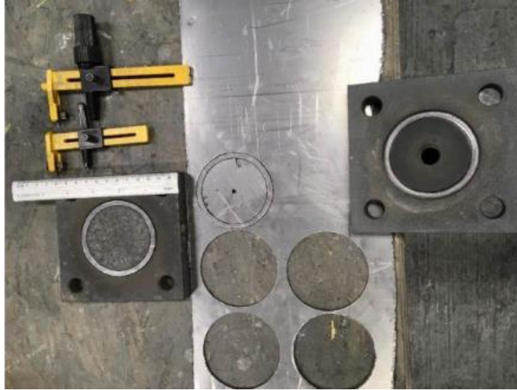
Figura 25. Elaboración de empaques de grafito para el sistema de infiltración.
