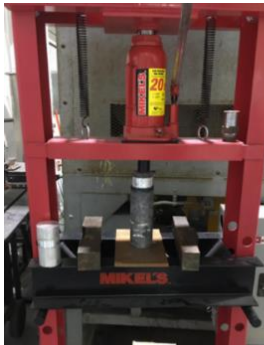
Figura 31. Extracción de probetas en prensa hidráulica.
