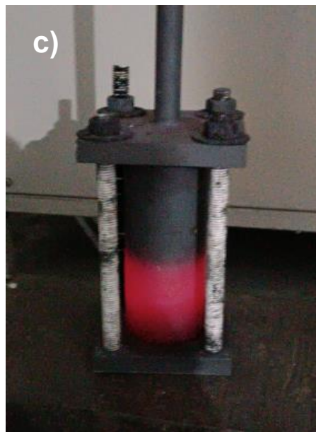
Figura 30. Etapas de la solidificación de espumas metálicas. a) muestra recién liberada del horno eléctrico, b) solidificación y c) enfriamiento de la espuma.
