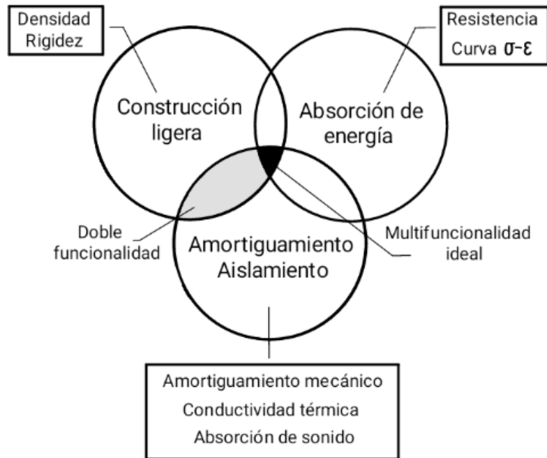
Figura 18. Esquema de una combinación ideal de propiedades mecánicas de espumas metálicas para su implementación en la industria automotriz [41].
