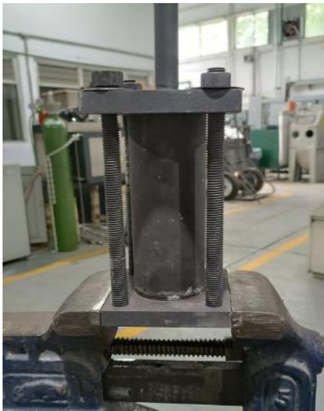
Figura 28. Sistema de infiltración ensamblado correctamente.
