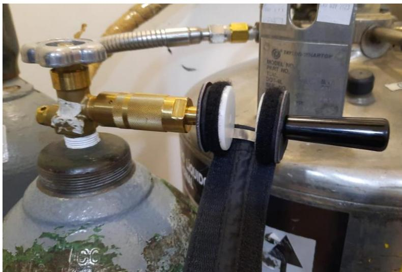
**Figura 12. Tanque de CO<sub>2</sub> con adaptador para pastilla.** El CO<sub>2</sub> sale a presión y comienza a llenar el adaptador hasta formar la pastilla de hielo seco.
