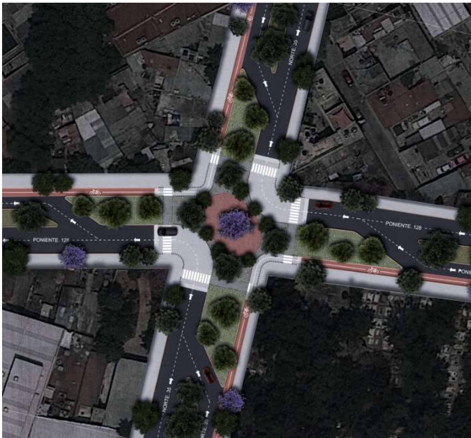
Imagen 159. Propuesta de intervención para Pte 128 – Norte 35. Elaboración propia.
