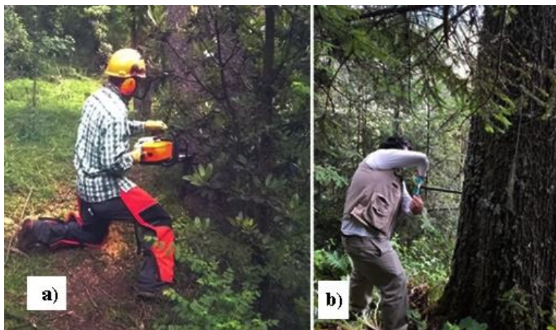
Figura 25. Toma de muestras. a) Toma de muestra con motosierra; b) Toma de muestra con el taladro Pressler .
