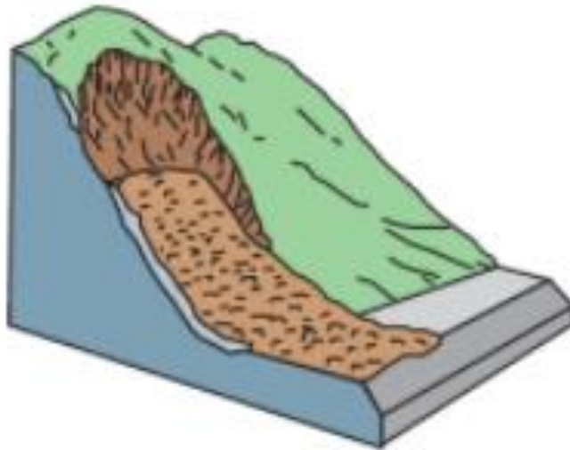
Figura 9. Esquema representativo de una avalancha de escombros. Tomado de Novotný (2013).
