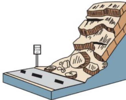
Figura 2. Esquema representativo de una caída de rocas. Tomado de Novotný (2013).
