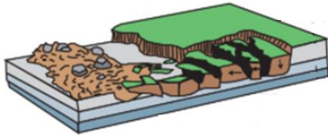
Figura 7. Esquema representativo de una extensión lateral. Modificado de Novotný (2013).
