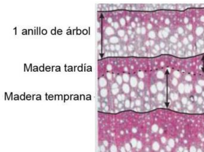
Figura 13. Esquema de la madera temprana y tardía en anillos de crecimiento anual. Las flechas indican el ancho del anillo, madera tardía y temprana, respectivamente, la línea negra indica dónde termina e inicia un nuevo anillo y la línea punteada señala el límite entre madera temprana y tardía. Modificado de Figueroa-García (2020).
