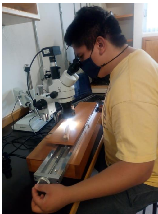
Figura 31. Medición del ancho de los anillos de crecimiento en las muestras empleando un estereoscopio conectado a una platina deslizante (VELMEX) para su registro mediante el programa MeasureJ2X .
