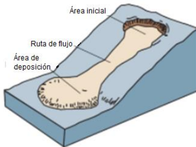
Figura 10. Esquema representativo de un flujo de tierra. Modificado de Novotný (2013).
