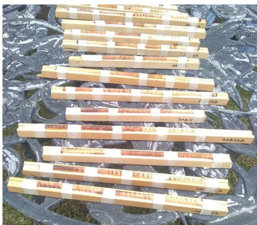
Figura 27. Técnica de montaje de las muestras. Se aprecia la base de madera sobre la cual se colocan y se asegura su adhesión mediante el uso de pegamento y cinta.
