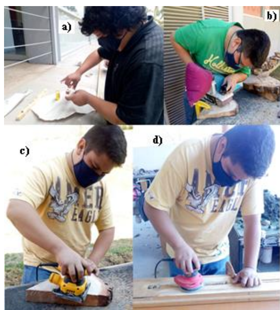
Figura 28. Proceso del preparado de las muestras. a) Montado de los núcleos en las bases de madera; b) Lijado de una cuña usando una lija del número 80; c) Lijado de una cuña usando una lija del número 320; d) Lijado de un núcleo usando una lija del número 320.
