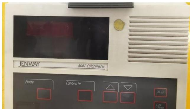
Figura 11. Colorímetro espectrofotómetro marca Jenway.
