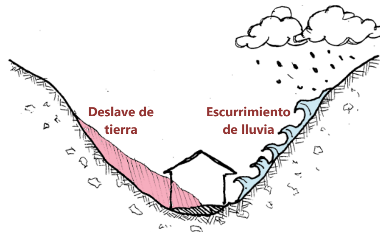
Casa propensa a deslave e inundación. Imagen adaptada de "Guía para la construcción de viviendas sismo-resistentes en mampostería confinada" (p. 29), por COSUDE, 2017.
