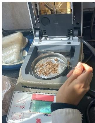
Figura 7. Balanza de humedad MB35 Ohaus.
