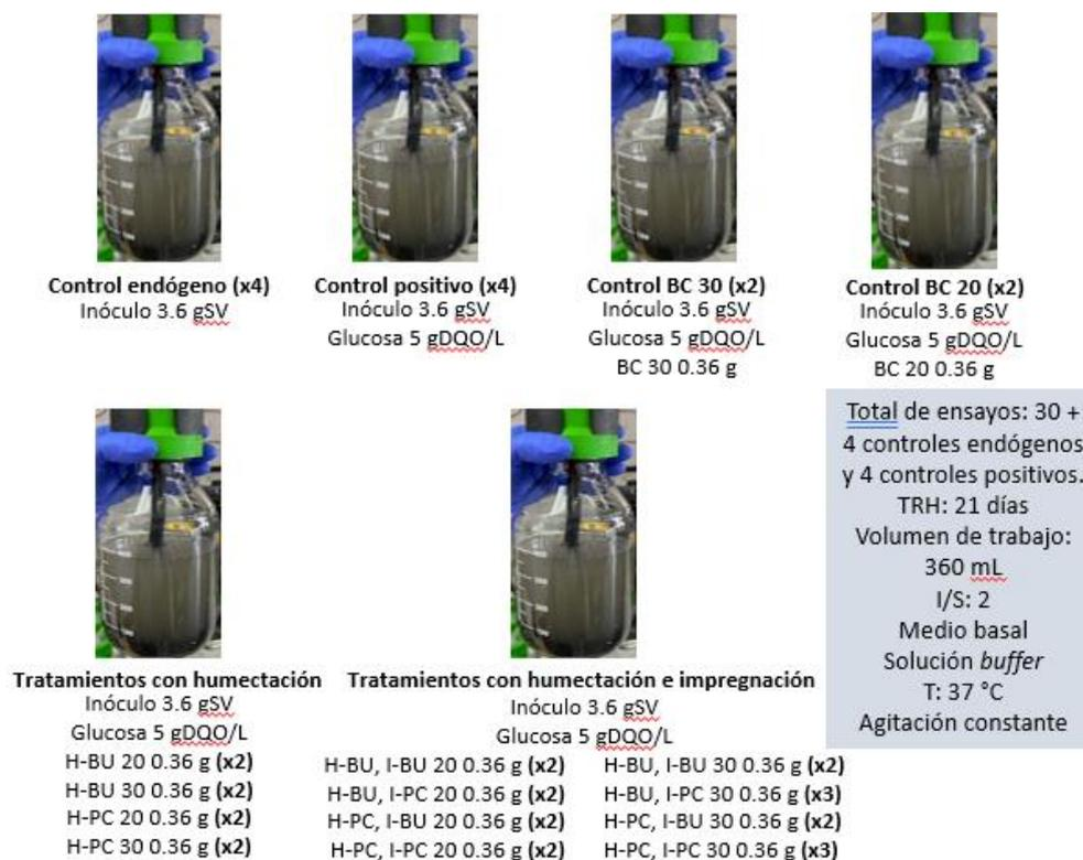
Figura 29. Configuración de las pruebas de potencial bioquímico de metano (elaboración propia).
