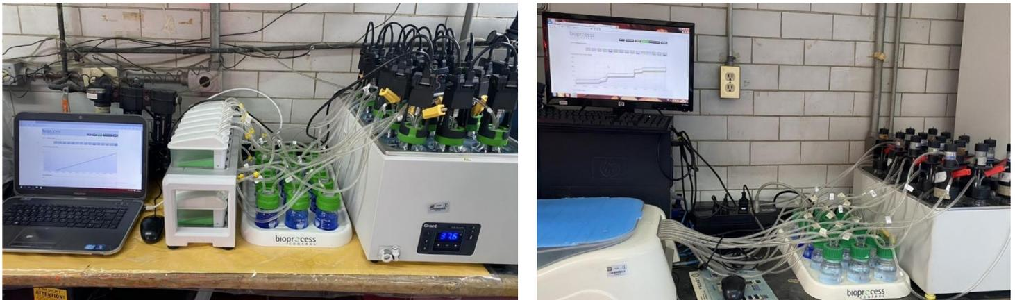
*Figura 14. Sistema Automático de Pruebas de Potencial de Metano de Bioprocess Control.*
