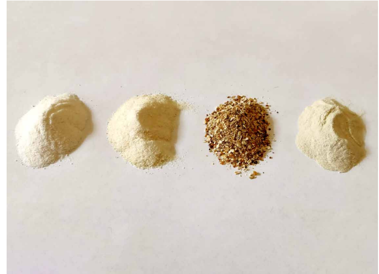
Figura 44. Polímeros naturales (agar-agar, grenetina, quitosano y goma xantana) usados durante las pruebas con agregados estandarizados.
