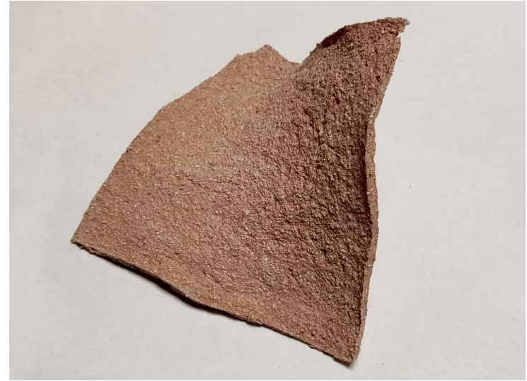
Figura 32. Prueba de material biobasado a partir de goma xantana y barro zacatecas.
