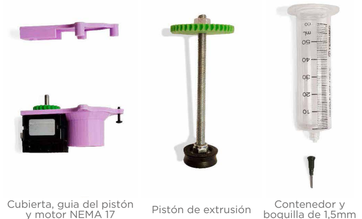
Figura 57. Partes del extrusor de pastas ocupado en la realización de pruebas de impresión.
