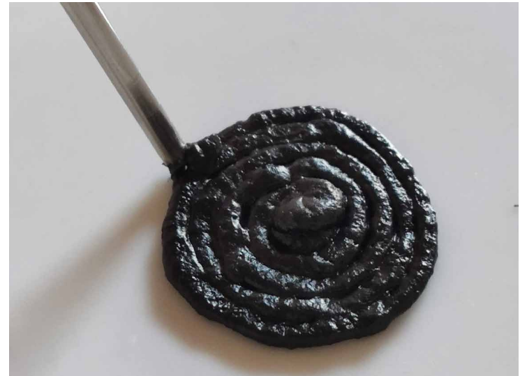
Figura 28. Prueba de extrusión manual, material biobasado a partir de almidón y carbón activado.
