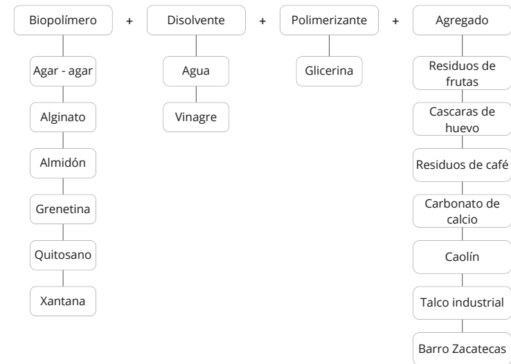
Figura 29. Diagrama sobre los componentes usados durante la investigación para realizar materiales biobasados.
