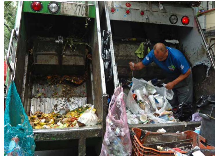
Figura 13. Camión recolector de residuos, con separación de residuos orgánicos y no orgánicos. Residuos profesionales, 2017, ( https://www.residuosprofesional.com/ciudad-de-mexico-cuatro-fracciones )
