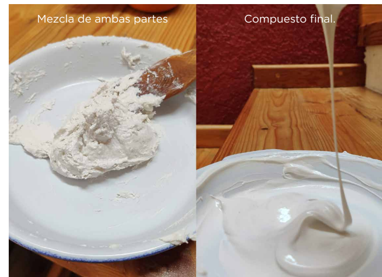
Figura 59. Proceso de elaboración del compuesto, integración de ambas partes del compuesto en una sola mezcla homogénea.
