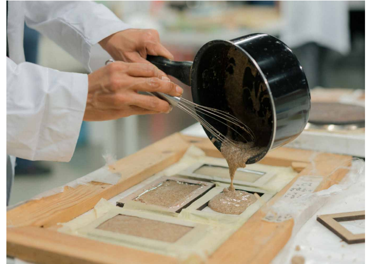
Figura 16. Vaciado de biocompuesto en moldes para muestras. FabLab Barcelona, 2021, ( https://fablabbcn.org/blog/emergent-ideas/biomaterials-101 )
