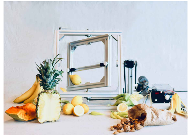
Figura 78. Bio rotomoldeadora, máquina rotomoldeadora para fabricar geometrías cerradas y huecas de biomaterial. FABLAB UCH, 2021, ( https://gitlab.com/fablab-u-de-chile/rotomoldeadora )
