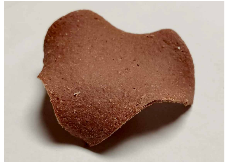
Figura 31. Prueba de material biobasado a partir de grenetina y residuos de mandarina.
