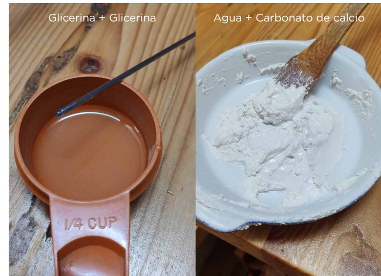
Figura 58. Proceso de elaboración del compuesto, mezcla individual de polímero natural con glicerina y carbonato de calcio con agua.
