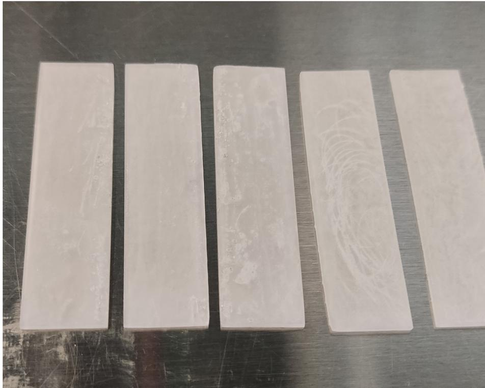
Figura 3.12. Fotografía de las probetas impresas para los ensayos de flexión.
