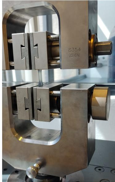
Figura 3.18. Ejemplo de la colocación de las probetas de tensión en la máquina universal.
