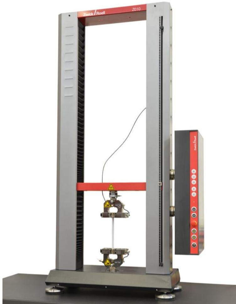
Figura 3.14. Imagen de la máquina universal para la realización de los ensayos mecánicos. Fotografía tomada de: <http://www.interempresas.net/>.
