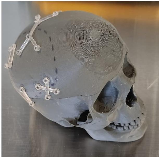
Figura 2.6. Ejemplo representativo de suturas craneales fabricadas a través de impresión SLA.
