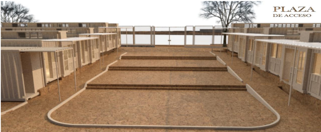
Imagen 53. Plaza de acceso, escalones y rampas laterales, con losetas táctiles para personas ciegas y débiles visuales Fuente: autoría propia
