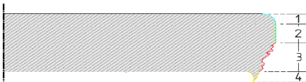
Figura 1.7 – Zonas en los bordes, 1) redondeado, 2) bruñido, 3) fractura, 4) rebaba. [1]
