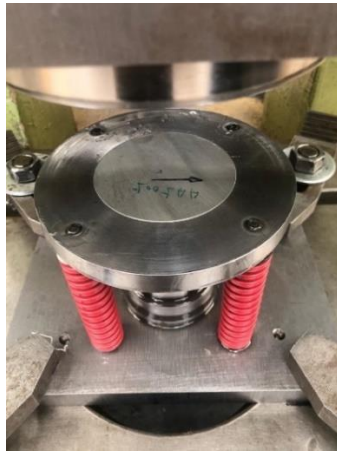
Figura 3.4 – Disco de AA5005 listo para embutir.
