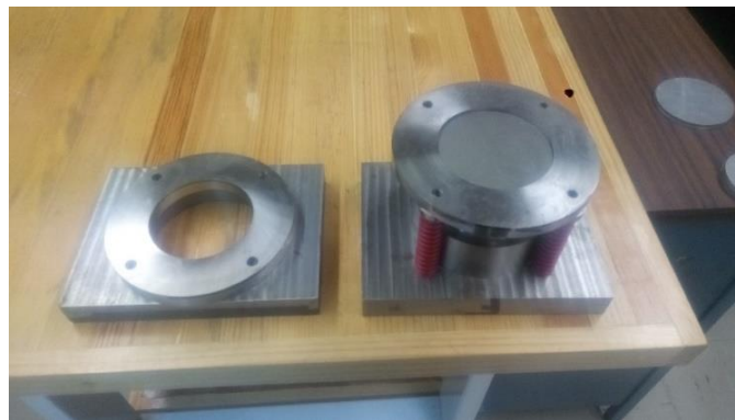
Figura 2.5 - Troquel de corte para discos de 85mm.
