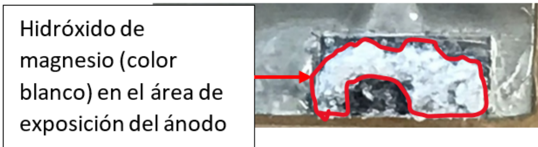
Figura 36: Restos de óxidos e hidróxidos generados en el área de exposición del ánodo de magnesio.
