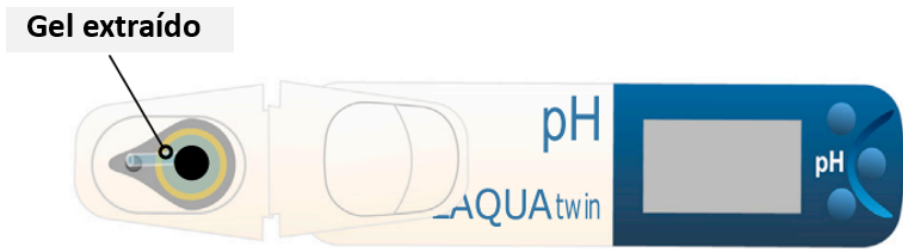
Figura 10: Esquema representativo del dispositivo utilizado para realizar las mediciones de pH. Para las mediciones de conductividad se utilizó un dispositivo similar.
