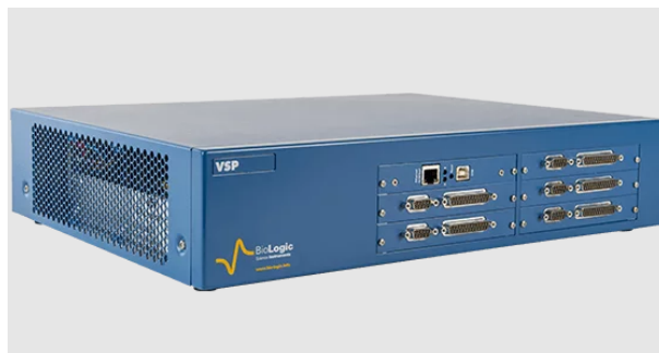
Figura 1.4: Fotografía del potenciostato marca Biologic y modelo VSP utilizado para los barridos en la experimentación.
