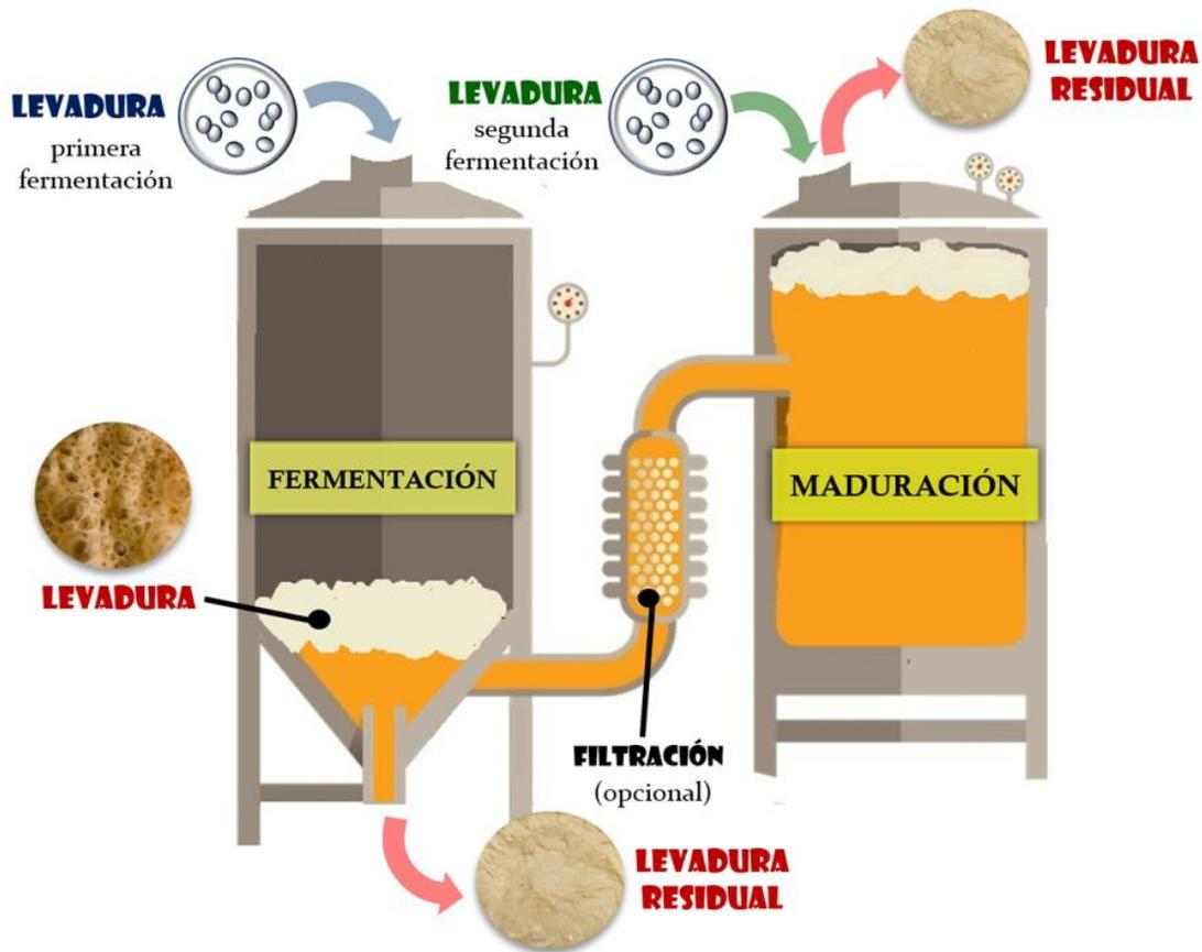
**Figura 5.15. Esquema de la obtención de la levadura residual durante la elaboración de cerveza.**
