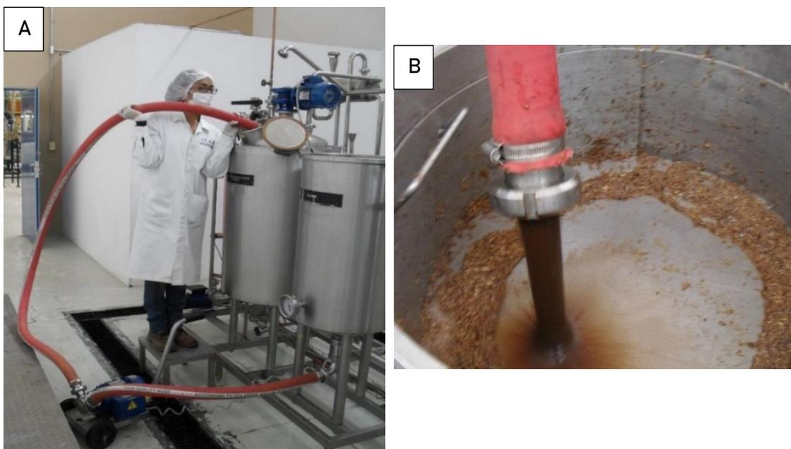
**Figura 5.3. A) Etapa unitaria, separación del grano agotado del mosto dulce; B) Flujo del mosto dulce a través del filtro-prensa.**
