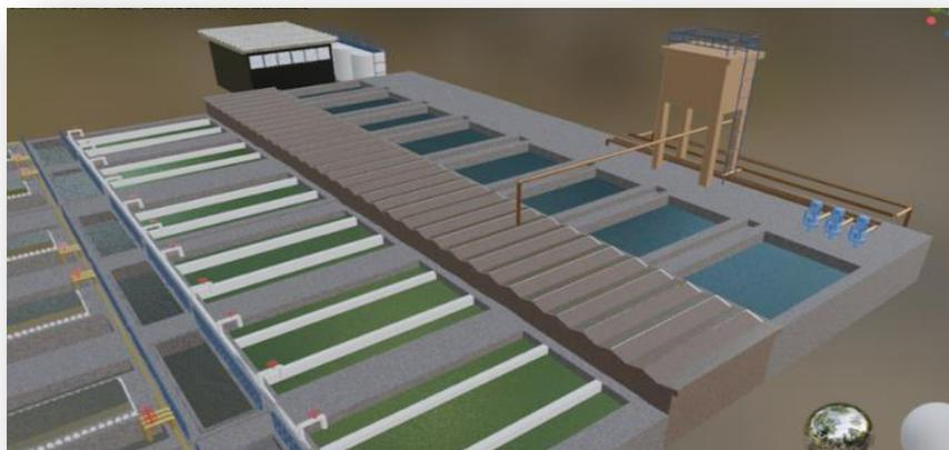
**Figura 21.** Sistema de Filtración y Estación de Cárcamo de Bombeo.
