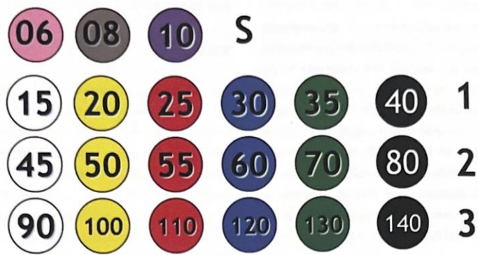
Figura 12. Estandarización de limas. Limas especiales S, Serie 1, Serie 2, Serie 3. 17
