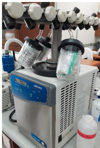
Figura 13. Liofilizadora marca Labconco® modelo Free Zone® 998778
