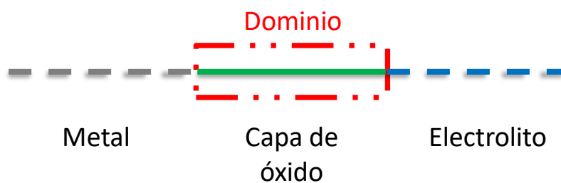
FIGURA 2.3 DELIMITACIÓN DEL DOMINIO PARA EL MODELO NÚMÉRICO EN UNA DIMENSIÓN
