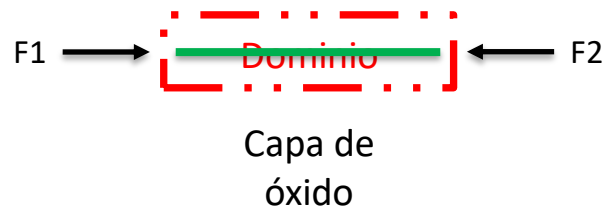
FIGURA 2.4 DOMINIO CONSIDERADO PARA EL MODELO NUMÉRICO EN UNA DIMENSIÓN
