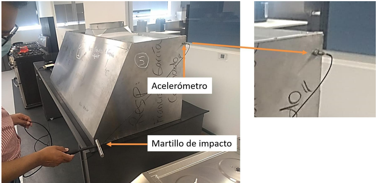
Figura 47. Setup experimental. Frecuencias naturales.
