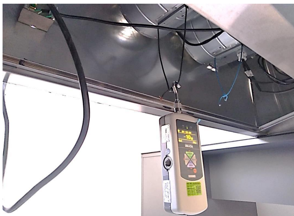
Figura 42. Ejemplificación de cómo sirven las cuerdas para sujetar el dinamómetro.
