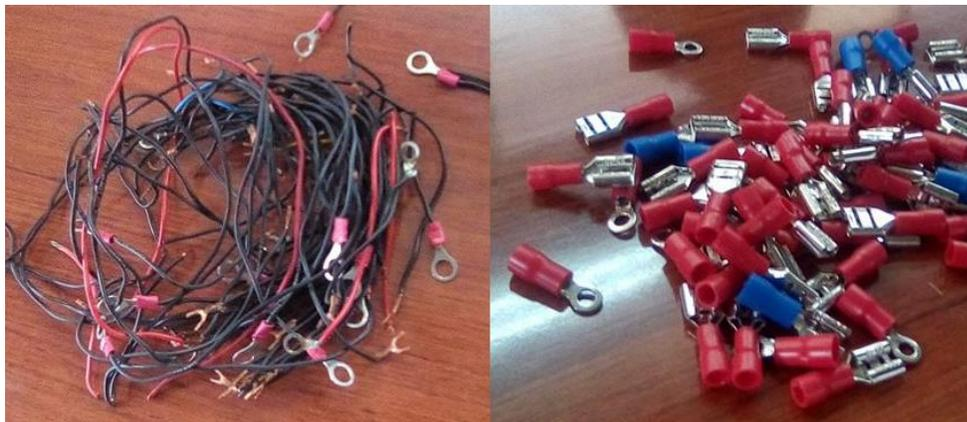
Inicialmente se comienza con el cableado de menor longitud para las conexiones pequeñas que van de los plugs y los push button (Figura 4.36), se toma una medida estándar y de esta se realizan varios trozos para conexiones similares. Así mismo se usaron terminales de ojillo para los plugs y terminales hembra para los Push button dejando en el cable una tolerancia para realizar el peinado (Figura 4.37).
