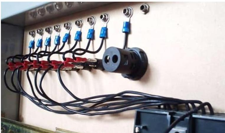
Una vez que todas las conexiones ya se encuentran realizadas se procede a realizar el peinado metiendo a cada dos cables un cincho de nylon para que no se pierda el inicio y término de cada cable.
