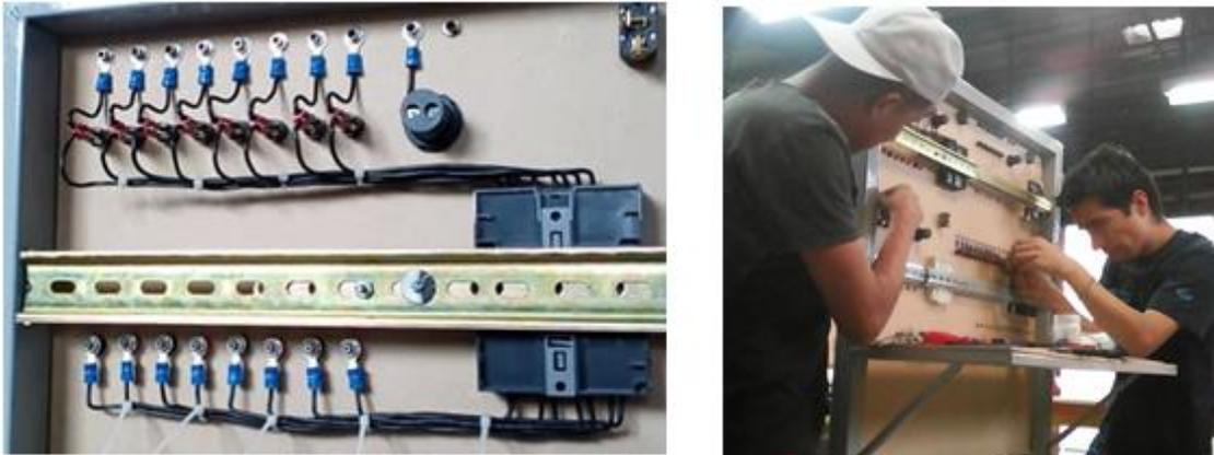
El cableado de los plugs a las lámparas consta de dos cables cortos, solo el extremo de cada uno llevará terminal de ojillo, el número de lámparas utilizadas en el módulo son ocho; cuatro para cada uno de los relevadores y cuatro para lámparas en el inferior de la cara frontal (Figura 4.43), sirviendo así para conexiones externas.
