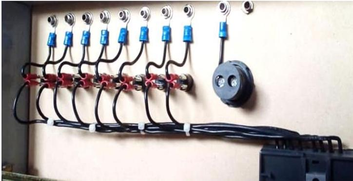
El cableado del relevador a los plugs de salida se realiza de la misma manera que al de los push button solo que en sus extremos llevan terminal de ojillo (Figura 4.41). El peinado será más pegado al MDF frontal ya que así lo permiten las terminales (Figura 4.42).
