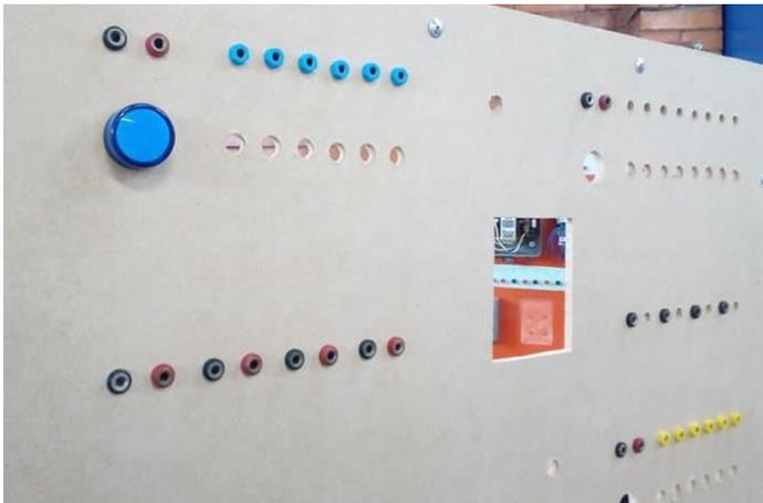
En primeras instancias los plugs no presentaron algún problema de colocación, así como los switch, sin embargo, los push button requerían que su orificio fuera un poco más extendido pero que a su vez el orificio no se excediera para que las piezas estuviesen ensambladas correctamente (Figura 4.27).
