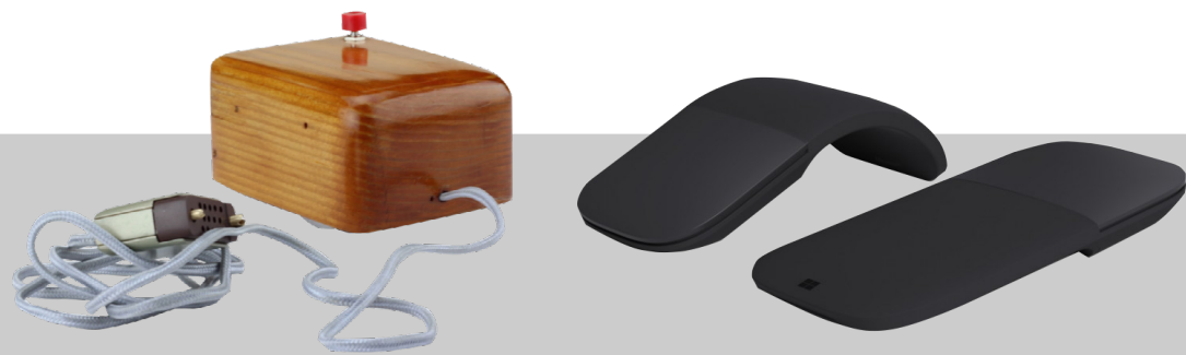
Fig. 14 338 A la izquierda, el primer mouse diseñado en 1964 por Engelbart y English fabricado en madera. A la derecha, el “Microsoft Arc Mouse” diseñado para adaptarse a la mano y se desdobra para que quepa fácilmente en su bolso.
