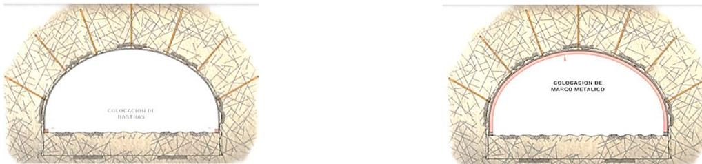
Imagen 55.-Colocación de rastras y marcos metálicos. Fuente: Procedimiento constructivo túnel carretero, youtube.
