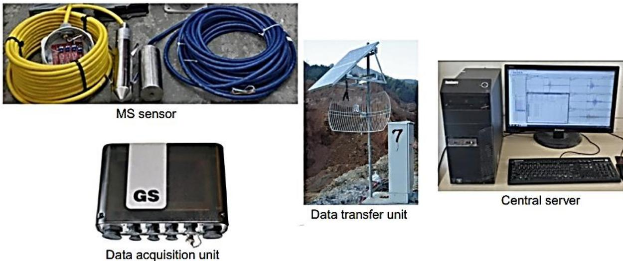
Imagen 69.- Composición del sistema de Microsismicidad Fuente: (Feng 2018)
