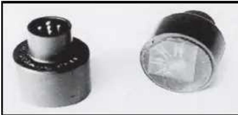
Imagen 23.- Instrumento de medición de esfuerzos CSIR Doorstopper. Fuente: (Blondel Buijuy, 2017)
