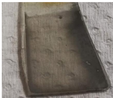
Fig. 63 Película de WO_3 pre-tratada después de 5000 ciclos de inserción-extracción
