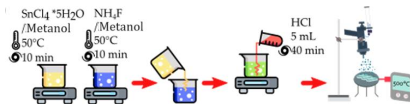
Fig. 19 Procedimiento experimental para la fabricación de películas delgadas de FTO
