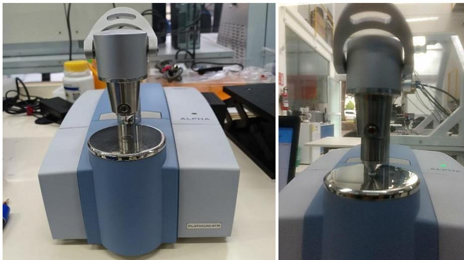
Figura 15 Equipo FTIR Alpha Bruker
