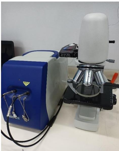
Figura 16 Espectrómetro i-Raman B&W Tek
