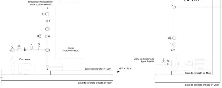
DETALLE DE CONEXIÓN CON EQUIPO HIDRONEUMÁTICO
