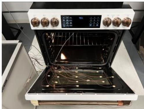
Fig. 22. Set-up experimental, con termopares colocados y adquisidor de datos.
