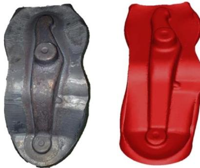
**Figura 2.11 Comparación de pieza real forjada vs el modelo numérico (Hawryluk y Jakubik, 2016)**
