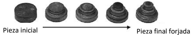
**Figura 2.5 Secuencia de forjado en frío (Lee et al., 2002)**
