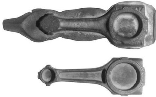
**Figura 2.22 Comparación entre forja de precisión vs convencional de una biela (Doege y Bohnsack, 2000)**
